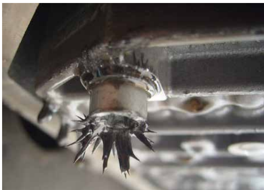
Mágnesesződött fémreszelék-lerakódás a váltóban
