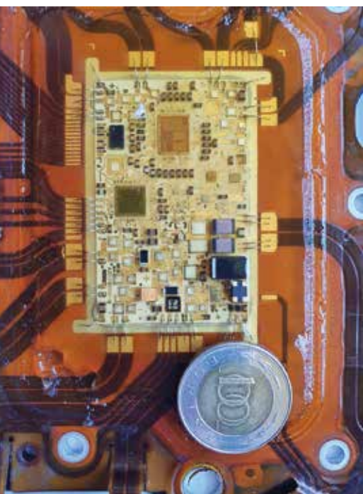
Az elektronika hibrid részének mérete egy érméhez hasonlítva
